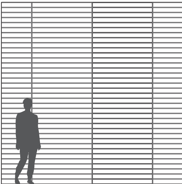
Troldtekt v-line 2way 6 monterad i horisontellt helförband.
