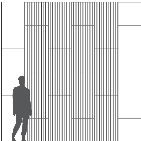
Troldtekt v-line 1way 10 monterad i vertikalt halfförband med Troldtekt v-line 1way blank på sidorna.
