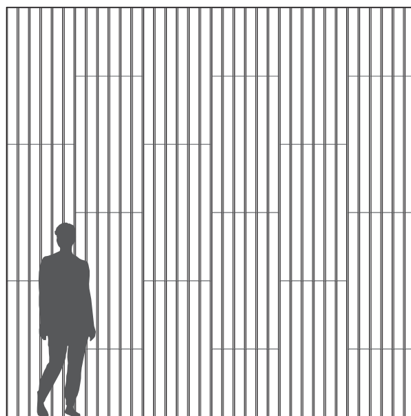
Troldtekt v-line 1way 6 monterad i vertikalt halfförband.
