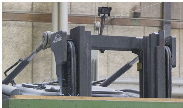
En kamera har installerats på gaffeltrucken, så att föraren ges bättre sikt och kan identifiera eventuella risker via en monitor i förarhytten.
