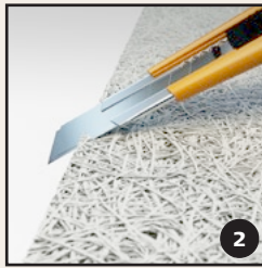
Använd en kniv och skär ut en liten bit cementbunden träull från en överbliven panel eller en provpanel
