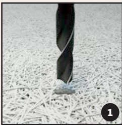
Använd träborren för att göra hålen lika stora i diameter.
