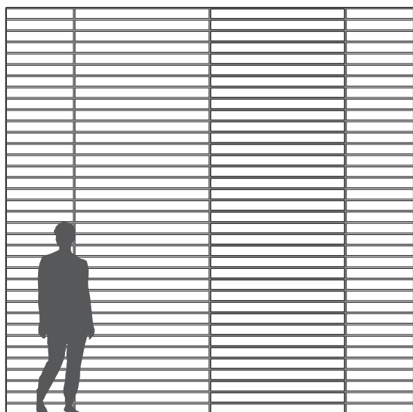
Troldtekt v-line 2way 6 monterad i horisontellt helförband.
