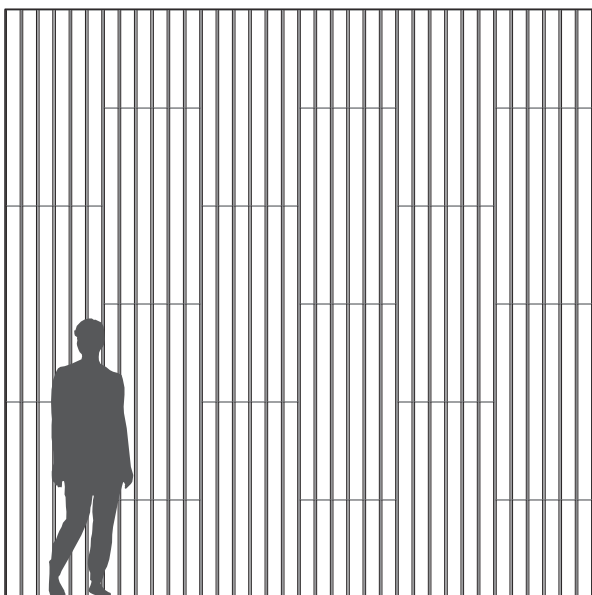
Troldtekt v-line 1way 6 monterad i vertikalt halvförband.
