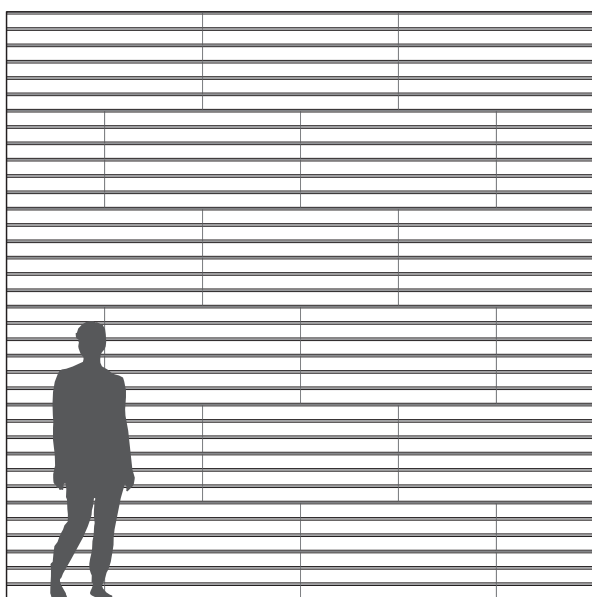
Troldtekt v-line 1way 6 monterad i horisontellt halvförband.
