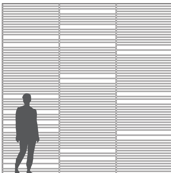
Troldtekt line design med vågrät montering
