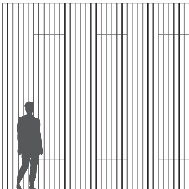
Troldtekt v-line 1way 6 monterad i horisontellt halfförband.
