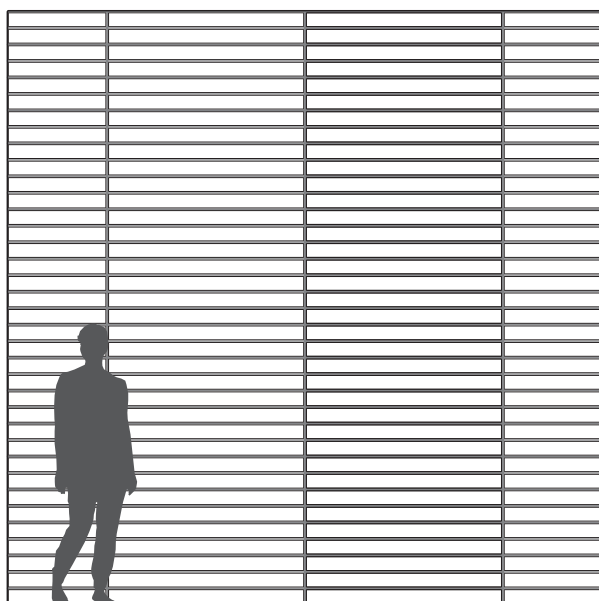
Troldtekt v-line 2way 6 monterad i horisontellt rutförband.
